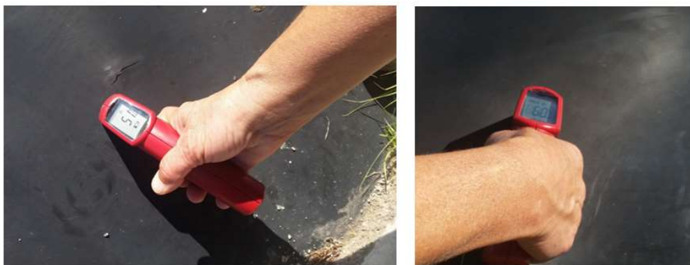
Figura 38. Medida de la temperatura de la geomembrana durante las inspecciones
