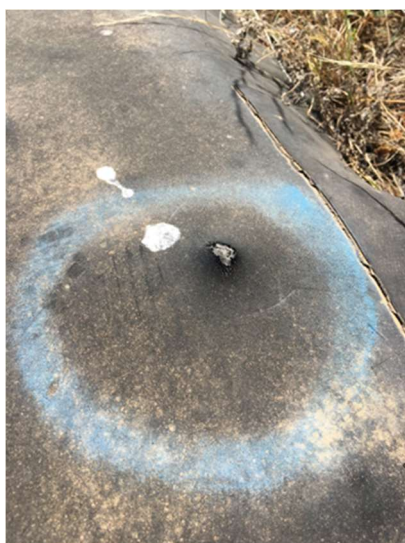
Figura 26. Punzonamiento en lámina de EPDM (arriba) y posterior propagación de punzonamiento en forma de desgarro (abajo)
